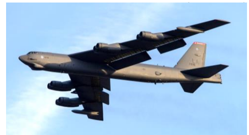
B52戦略爆撃機(ボーイング社): 8基のエンジンを搭載、 成層圏の要塞 全長48m、翼巾58m。
